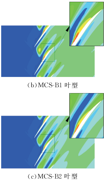
图 20 典型叶型 95%叶高截面熵分布 Fig. 20 Distribution of entropy at 95% span section
